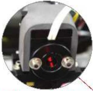
**Laser à semi-conducteurs avec chauffage**
