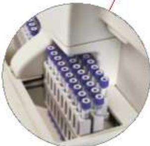
**Chargeur automatique avec 50 positions de tube**
